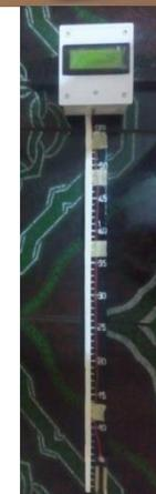
Soil Moisture Reflectometer
