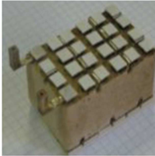
Innovative Mg-Si/Mn-Si-Ge Thermoelectric Module (Ecole des Mines de Nancy)
