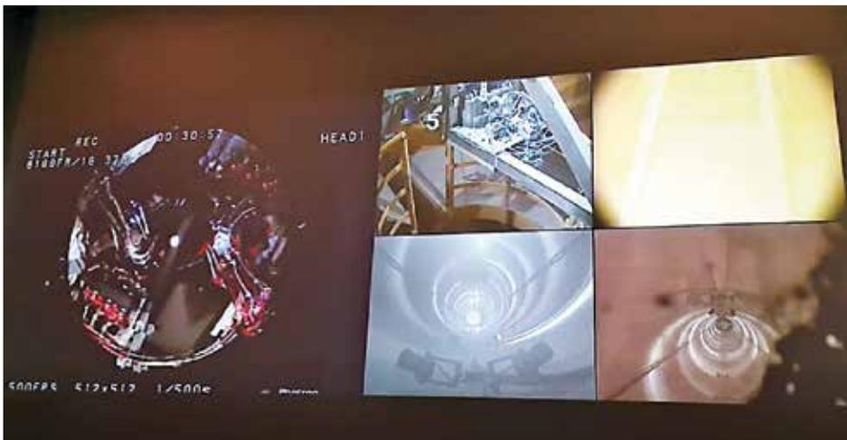
Figura 6. Vista de la ejecución de un experimento desde el centro de mando en la torre de microgravedad. En la imagen se visualiza el prototipo desde la cámara superior en la cápsula (izquierda), y las tomas dentro del conducto de lanzamiento durante la caída de la cápsula.
